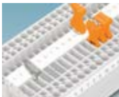
P-DI ayırma bıçağı ile devre istendiğinde ayrılabilir. Bıçak, yerine ters takılarak kaybolması önlenir
